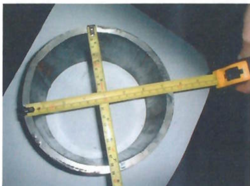
Figura 1 – Tubo teste ovalizado.
